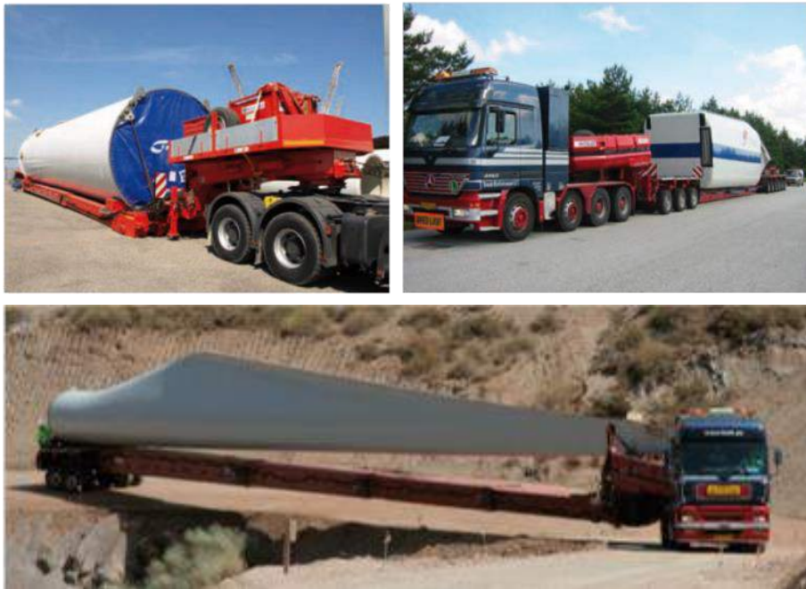
Abbildung 1: Herkömmliche Transportfahrzeuge wie Kesselbrücken (oben links), Flachbettbrücken (oben rechts) und Semi-Trailer (unten); Quelle: Scheuerle.
