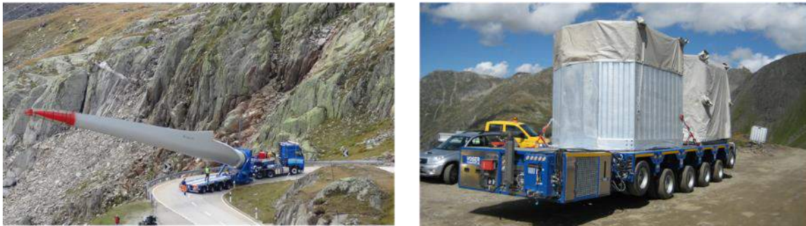
Abbildung 2: Spezielle Transportkombination mit Schwanenhals (links) und Selbstfahrer M4 (rechts); Quelle: New Energy Scout.
